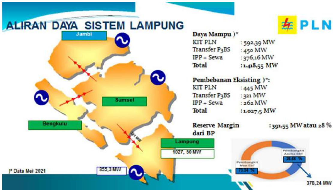
Gambar II-18 Aliran Daya Sistem Lampung
